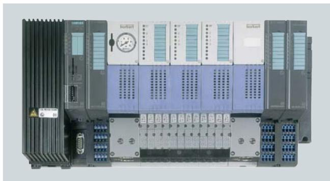
AirLINE Ex 8650 es una isleta neumática desarrollada especialmente para el sistema de periferia distribuida ET 200iSP de SIMATIC PCS 7, capaz de controlar de forma neumática procedimientos para procesos y fabricación en áreas con peligro de explosión de la zona 1/21. Al integrar la isleta neumática en la estación ET 200iSP, se amplían sus funciones eléctricas de E/S con funciones de mando neumáticas de 3/2 o bien de 5/2 vías.
