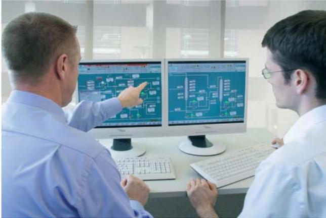
Con un Operator Training System (OTS) los operadores de la planta, ingenieros de la empresa y desarrolladores pueden practicar el manejo de la planta de producción y la reacción en función de la situación ante determinados eventos en un entorno de seguridad controlada. El OTS para el operador de la instalación en la industria química y farmacéutica es comparable con el simulador de vuelo de un piloto.
